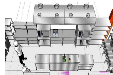
Лінія теплового обладнання
